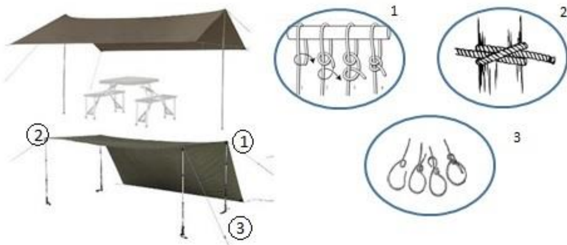
Рис. 5.9. Варианты установки тента и способы крепления оттяжек.
