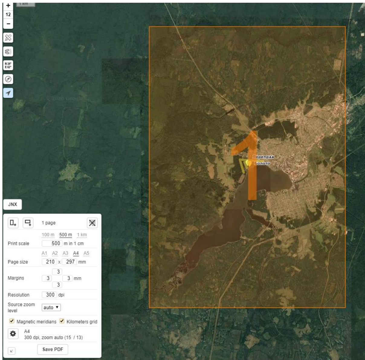
Рис. 4.13. Функция «PRINT MAP» (левый нижний угол) позволяет подготовить печатные картографические материалы в формате PDF
