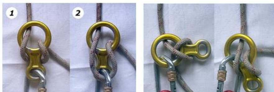
Рис. 5.5. Спуское устройство «восьмерка» и варианты его применения
