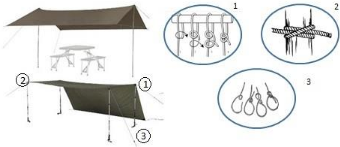
Рис. 5.9. Варианты установки тента и способы крепления оттяжек.
