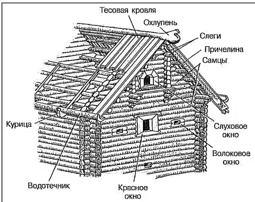
Рис. 8. Схема наименований деталей конструкций русской избы
